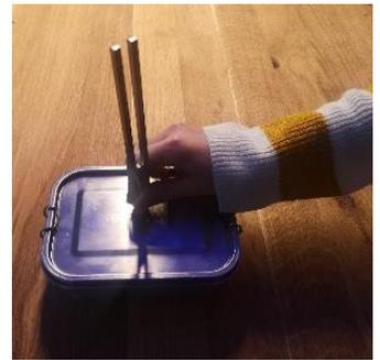
Bild 4: Schallverstärkung (Forscherstation)
